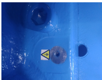
图 6.1 机器人底座地线连接处
