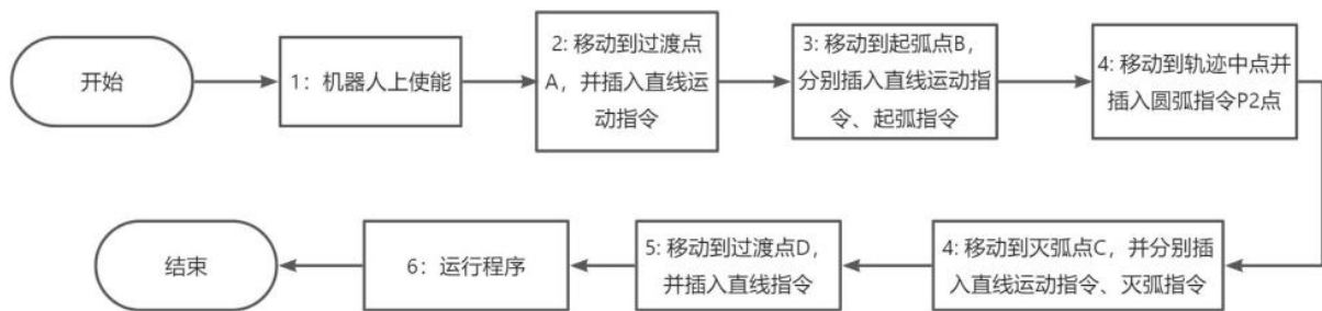
图 4.1.3 圆弧运动焊接操作流程
