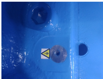
图 5.1 机器人底座地线连接处
