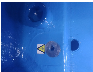
图 5.1 机器人底座地线连接处
