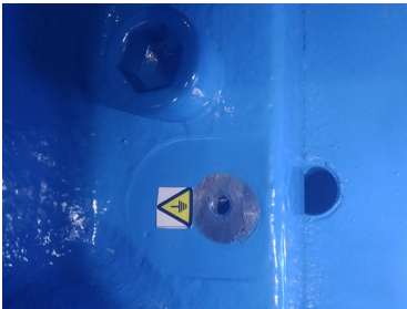
图 5.2.1 机器人底座地线连接处
