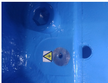
图 5.1 机器人底座地线连接处
