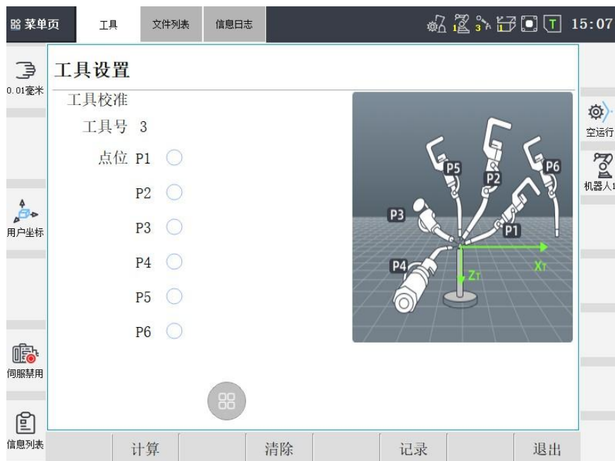
图 4.2.3 工具标定界面（六点校准）
