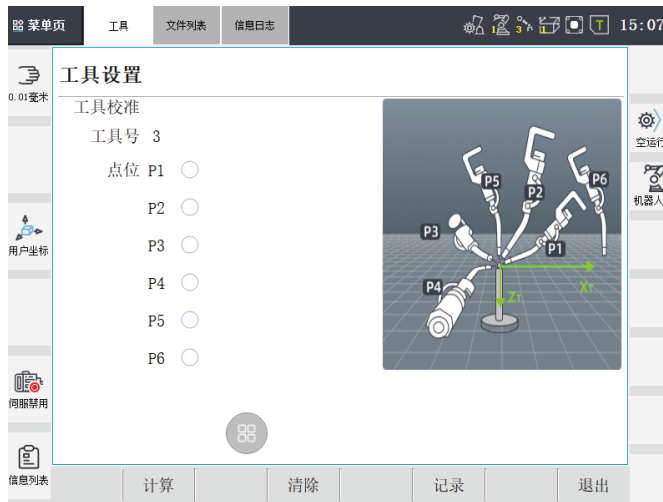
图 6.2.2 工具标定界面（六点校准）
