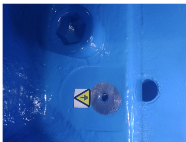
图 5.2.1 机器人底座地线连接处
